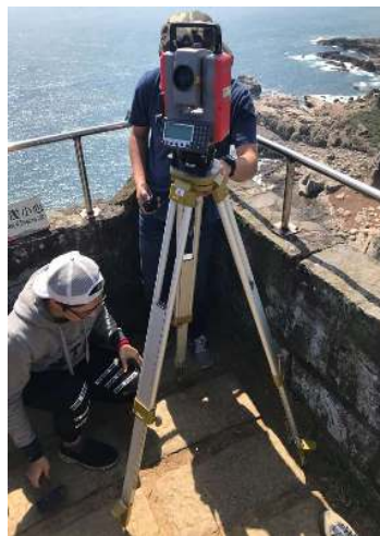
PENTAX R-425VN 免稜鏡紅外線光波全測站
